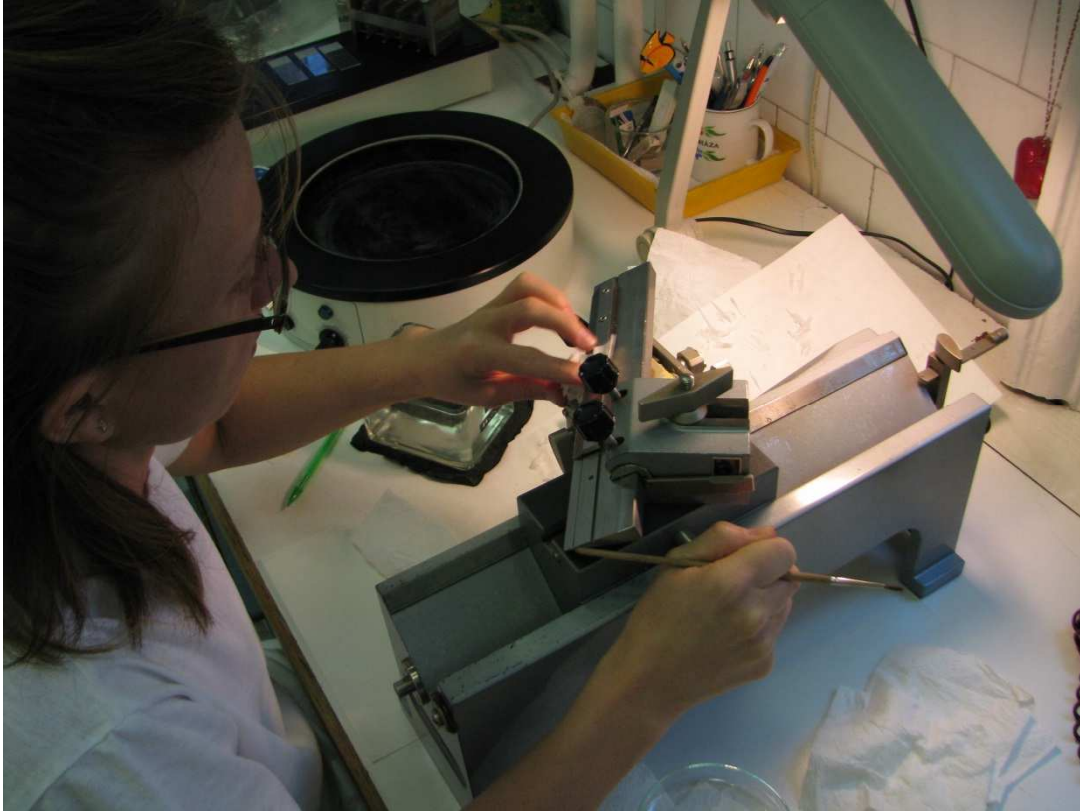
3. ábra: A paraffinos minta szeletelése
