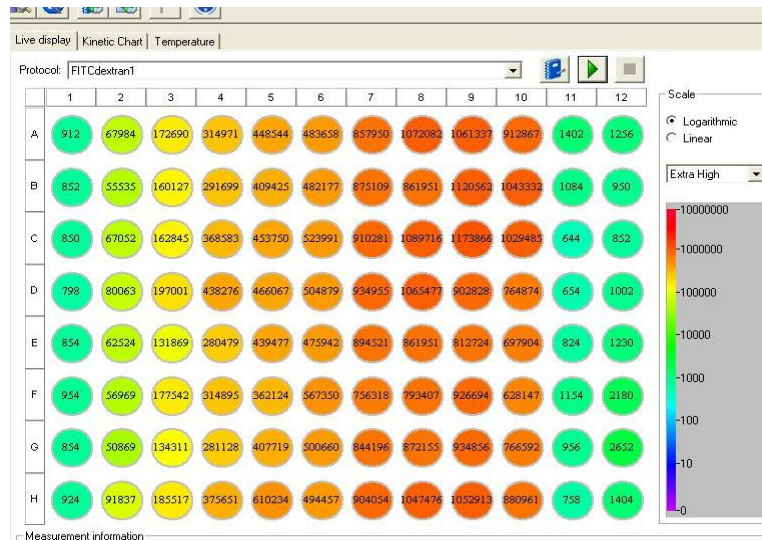
5. ábra A fluoriméter mérési adatainak megjelenítése FD4 mérések során. A kvantitativ méréseknél a megbízható méréstartomány 1000-500000 közötti fluoreszcencia intenzitás egységben definiált.
