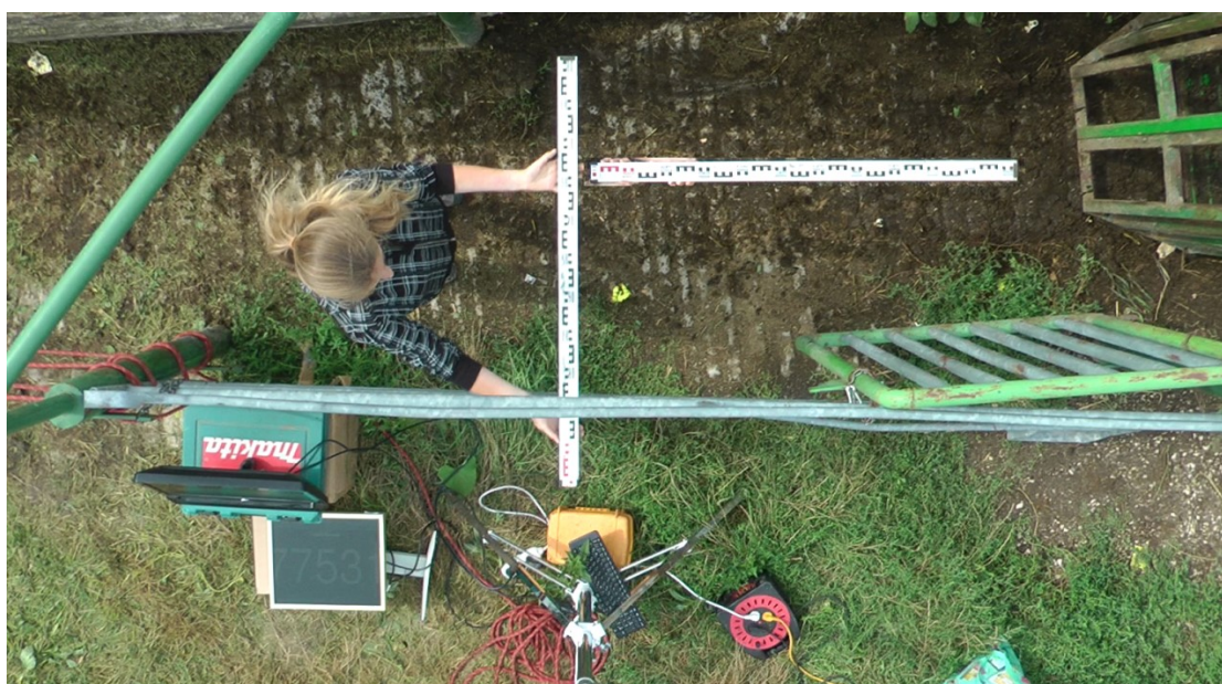
2. kép: Etalon felvétele Sarródon, bemásolva a méterrúd vízszintes síkban rögzített képe
