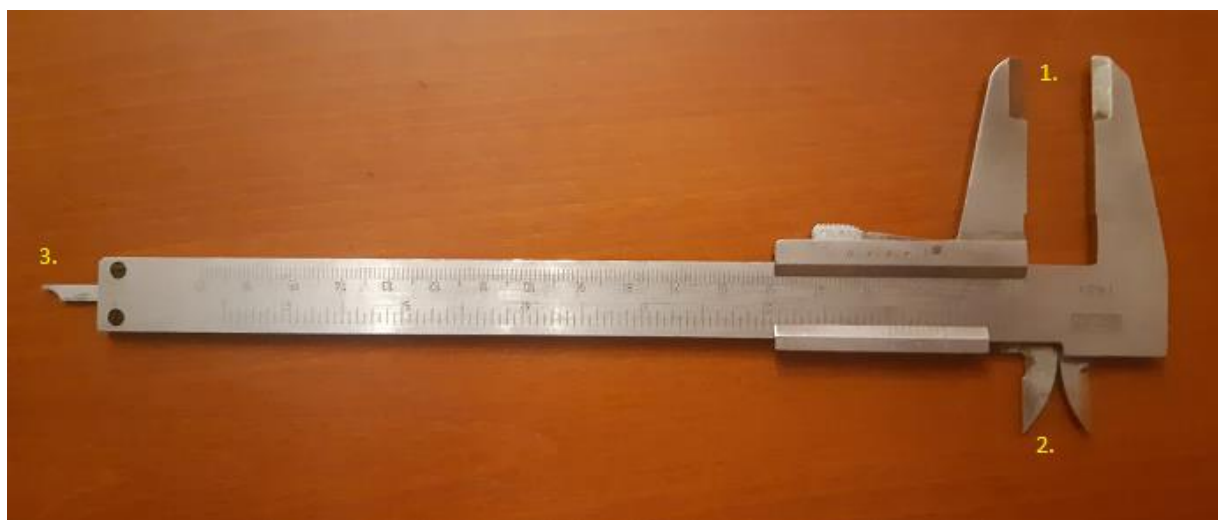
7. kép: A méréshez használt Somet márkájú műszerész tolómérő 1: Külső mérőpofa; 2: Belső mérőpofa; 3: Mélységmérő
