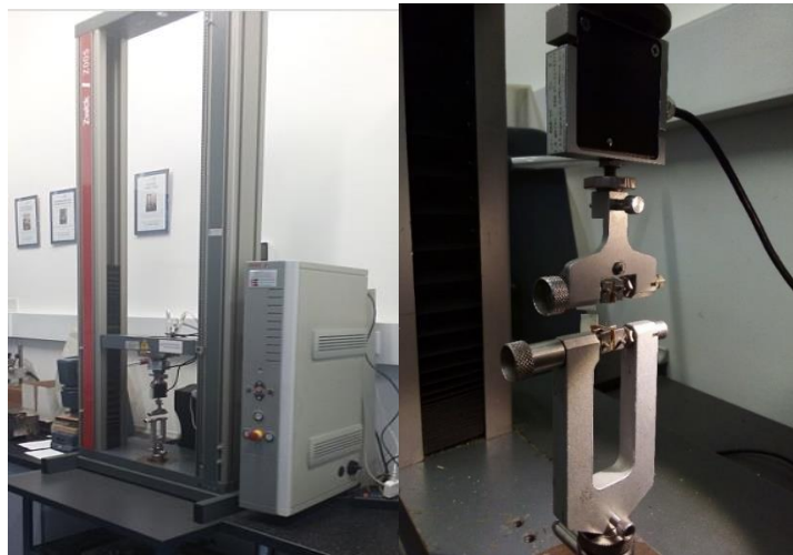
8-9. ábra: A befogott szőrszálminták szakítógépes vizsgálata A bal oldali képen a szakítógép, jobb oldalon pedig annak befogó része látható, melynek segítségével a szőrminták szakítási mérése történt.
