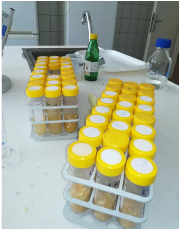
5. ábra: 50 ml-es PTFE centrifuga csövek a 10,0-10,0 g mintákkal
