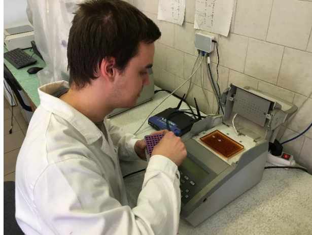
5. ábra: Az amplifikációra használt Mini Cycler készülék feltöltése mintákkal.
