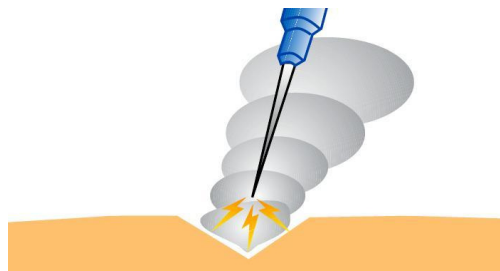
4. ábra. Az elektrosebészeti vágás sematikus ábrája. Az elektród nem érintkezik a kezelt szövetekkel. A köztes légréteg ionizációja eredményez elektromos kisüléseket és robbanásszerű vaporizációt (www.valleylab.com, 2011).
