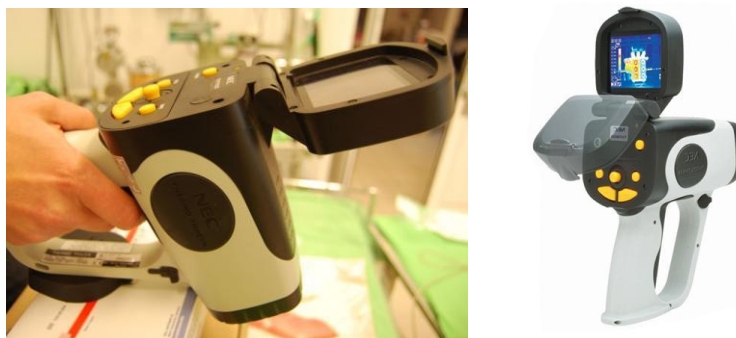
14. ábra. A hőterképezésnél alkalmazott NEC Thermo Tracer TH 7700 termokamera
