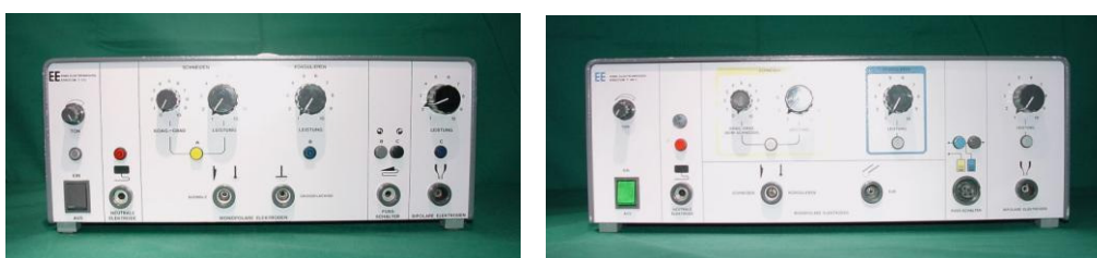
2. ábra. A SZIE ÁOTK Sebészeti Klinikáján jelenleg is alkalmazott Erbe Erbotom T 175D és Erbe Erbotom 400C elektrosebészeti generátorok (ERBE Elektromedizin GmbH, Németország)
