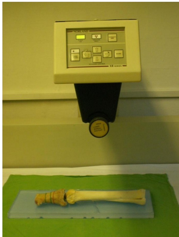
2. ábra – Ex vivo denzitometriás mérés Norland XR-26 készülékkel ló metacarpuson és csüdcsonton. A csontok alá helyezett 20mm vastag plexilap a hiányzó lágyszöveteket helyettesíti (Norland XR-26, Norland Corporation, Fort Atkinson, WI, USA)
