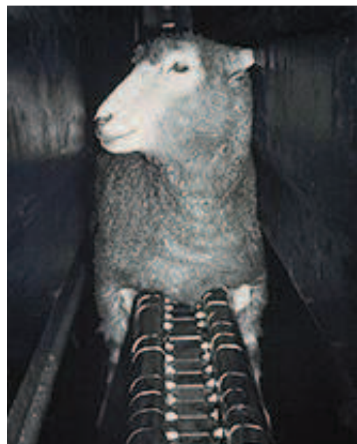
15. ábra Mozgószalagos rögzítő. Forrás: http://www.grandin.com
