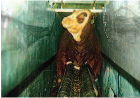
12. ábra Mozgószalagos rögzítő szemből. Forrás: http://www.grandin.com
