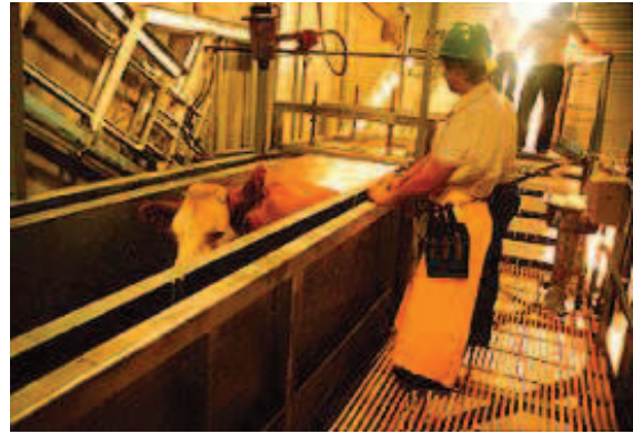
13. ábra Mozgószalagos rögzítő oldalnézetből. Forrás: http://www.grandin.com
