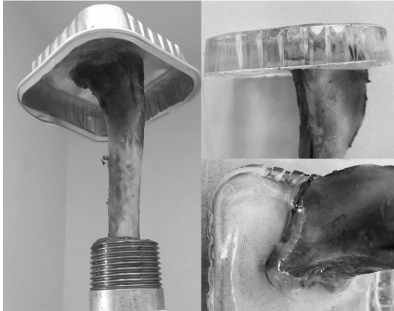
28. ábra: Kutya tibia proximalisan epoxi gyantába fogatva, distalisan pedig PMMA cementbe ágyazva (saját kép)
