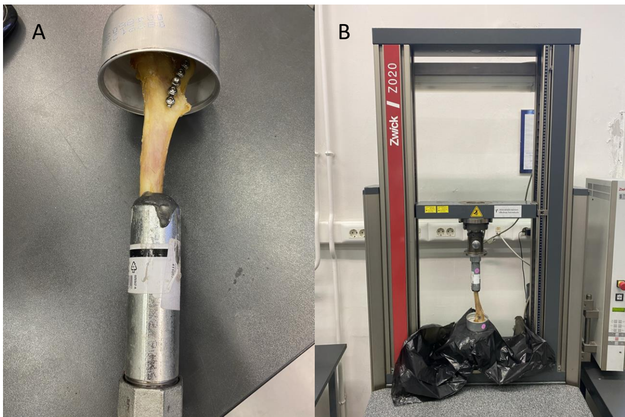
35. ábra: Tesztelésre kész minta (A), illetve a minta a ZWICK Z020-as szakítógépben (B) (saját kép)
