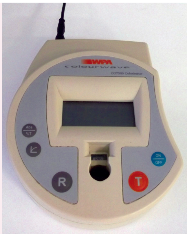
1. ÁBRA. A koloriméter az ejakulátumok sejtkoncentrációjának mérésére legszélesebb körben alkalmazott mérőmódszer telepi körülmények között
