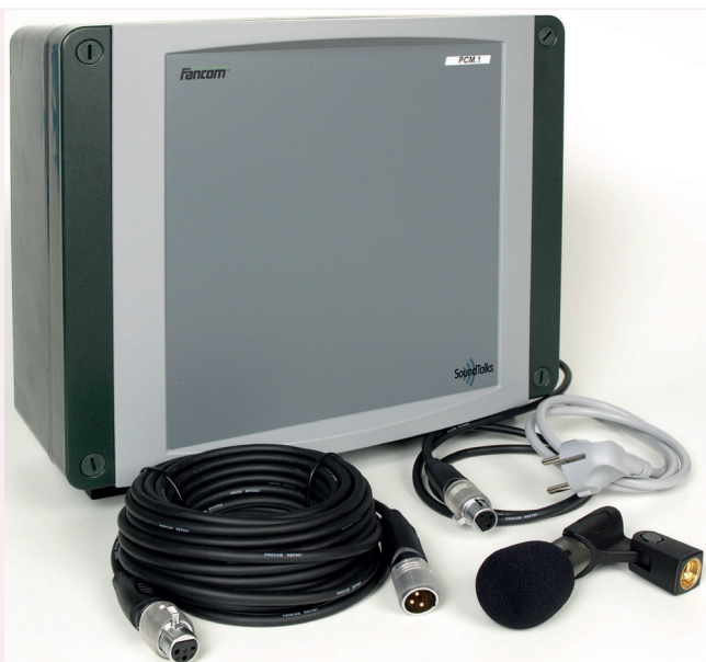
1. ÁBRA. A SoundTalks köhögésmonitora, mikrofonnal és mikroszámítógéppel
