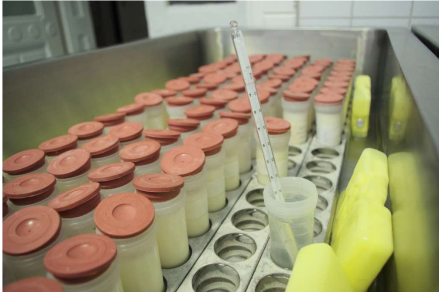
19. ábra: Nyerstej minták hőmérsékeltének beállítása összcsíraszám vizsgálathoz (a szerző felvétele)
