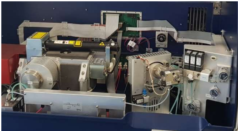
16. ábra: FT-MIR spektroszkópia elvén működő MilkoScan készülék (a szerző felvétele)
