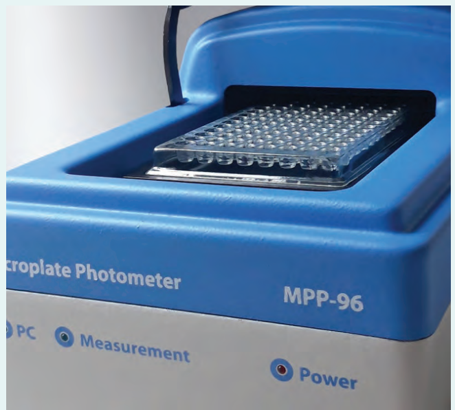
3. ÁBRA. A képen a leveshígításos mikromódszer során alkalmazott 96 lyukú mikrolemezt látható. Az inkubációs idő letelte után egy ELISA-leolvasó segítségével olvassuk le a kapott értékeket
