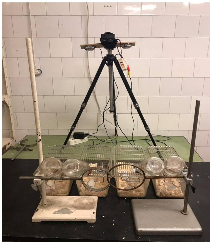
2. ábra: A hőkamerás mozgásmegfigyelési berendezésének elrendezése
