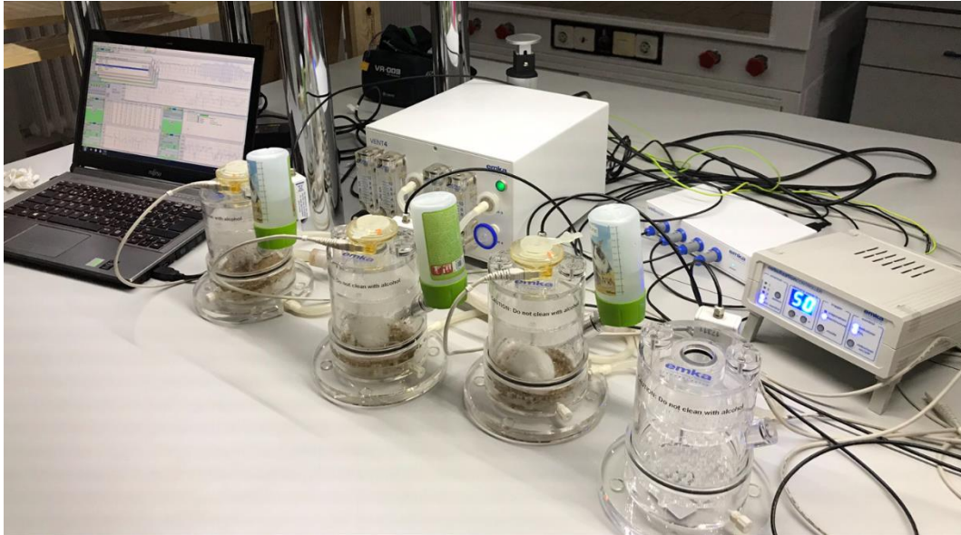
3. ábra: A cink-oxid inhaláltatásához használt teljes test pletizmográf berendezés általános összeállítása.
