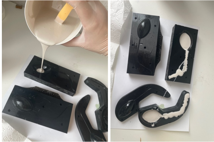
26. ábra Formák kiöntése Rubosil SR-30 szilikkonnal.
