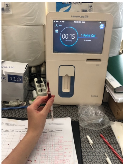
5. ábra: az iSmart Care 10 vérgáz- és elektrolit analizátor működés közben, illetve a mikroküvetébe töltött vérminta
