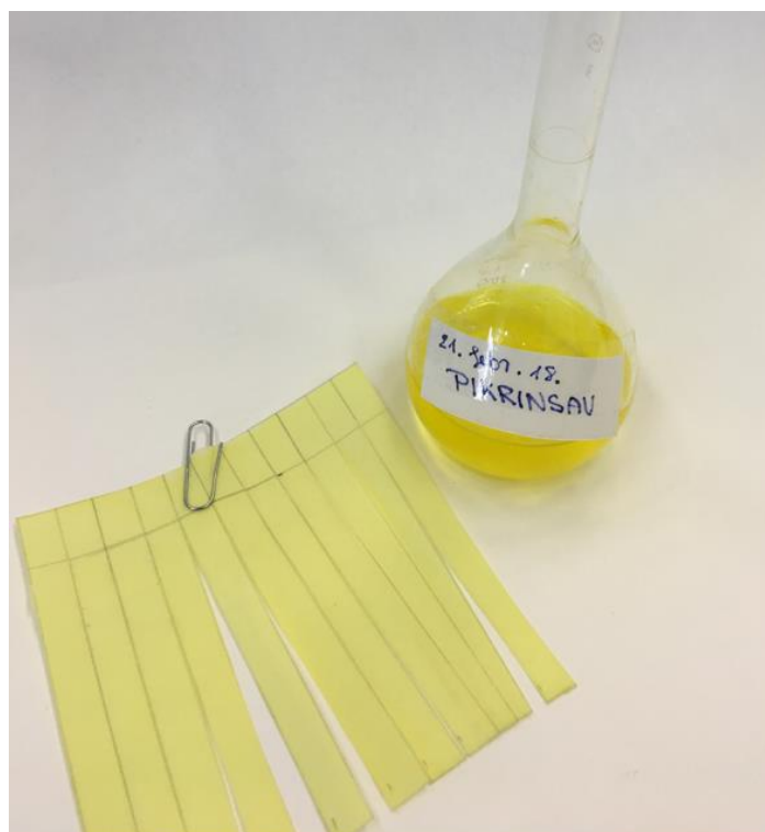
2.kép Pikrinsav és a pikrinsavba mártott, kiszáritott szűrőpapír csíkok
