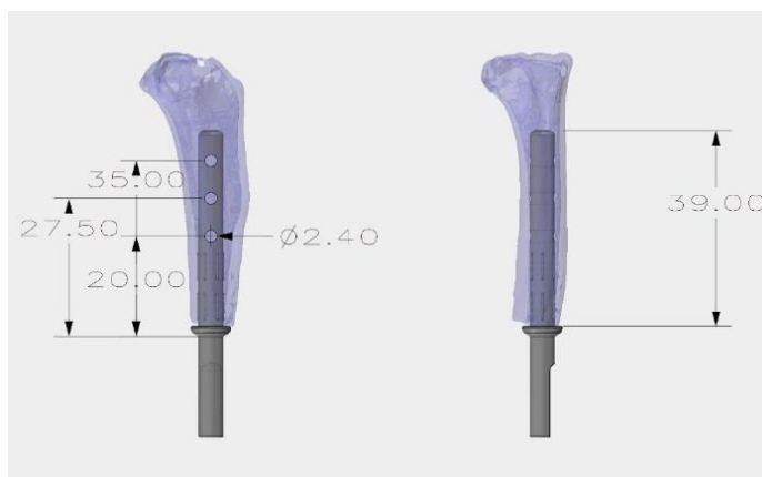
5. ábra: A legelső, még felépítésében eltérő, 3-csavaros implantátum terve (dr. Sebesztha Bence fotója)
