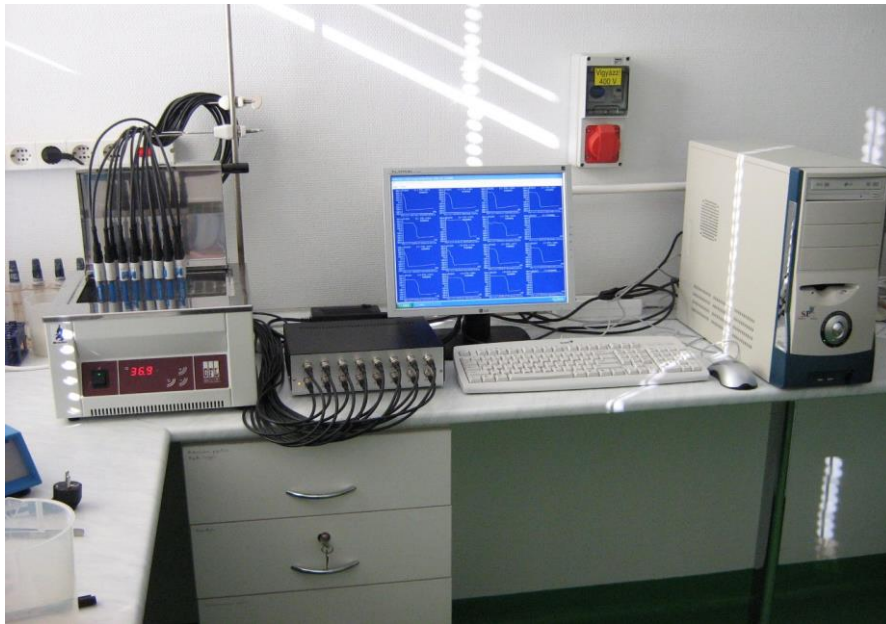
11. ábra 1 modulós, 16 csatornás MICROTASTER mérőrendszer
