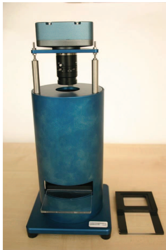
3. ábra. Az eredeti CollScope fénykép készítő eszköz a hozzátartozó becsúsztatható plexi tárolóval (Foto. Dombos Miklós)
