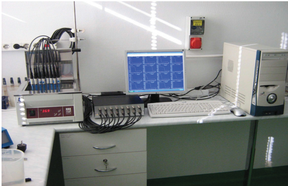
1. ábra 16 csatornás mérőműszer teljes kiépítéssel, Kémcsöves mérőcellákkal
