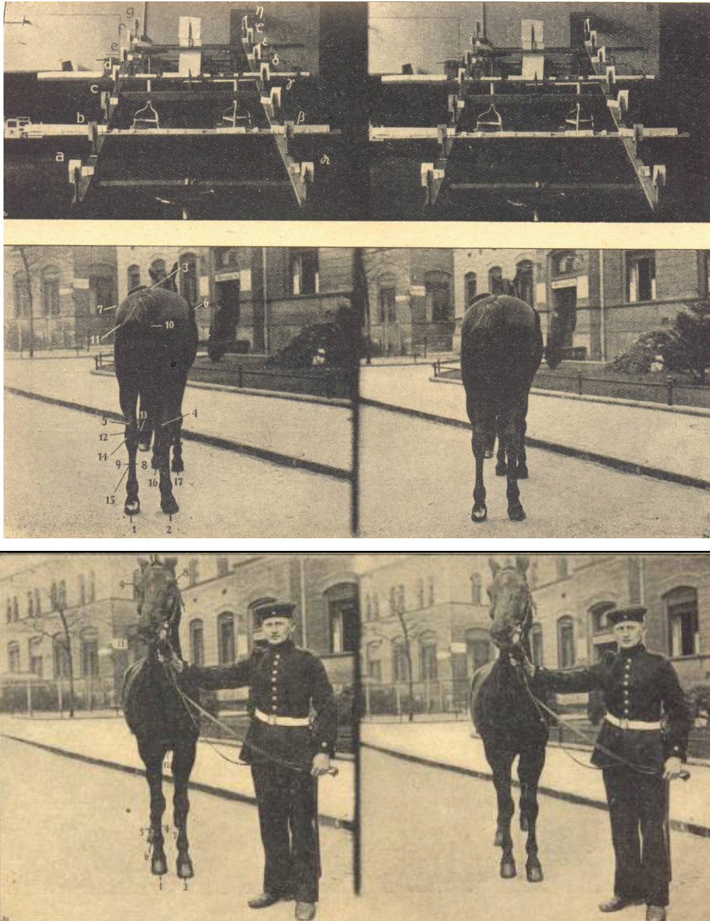
1. ábra: Lehmann sztereofotogrammetriás eszközei és a ló testméretfelvételhez készített hátul- és előlnézeti sztereofelvételek.
