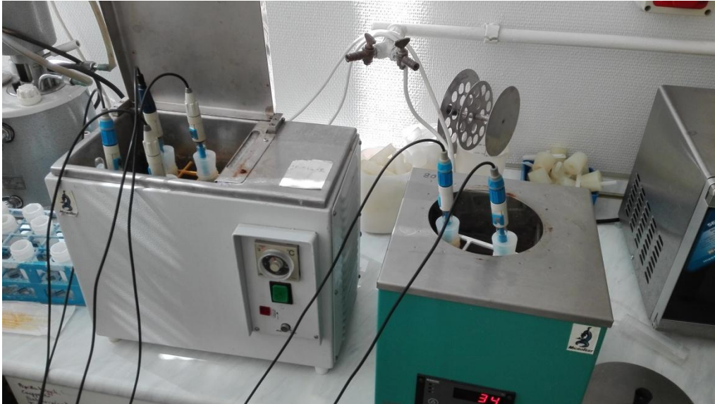
Mérőcellák vízfürdőben a csatlakoztatott mérőelektrodákkal
