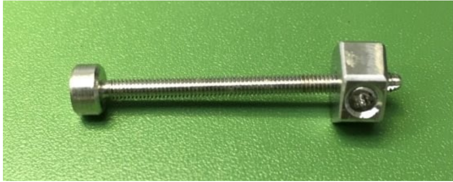
11. ábra: A szögstabil anyacsavaros csavar (saját kép)
