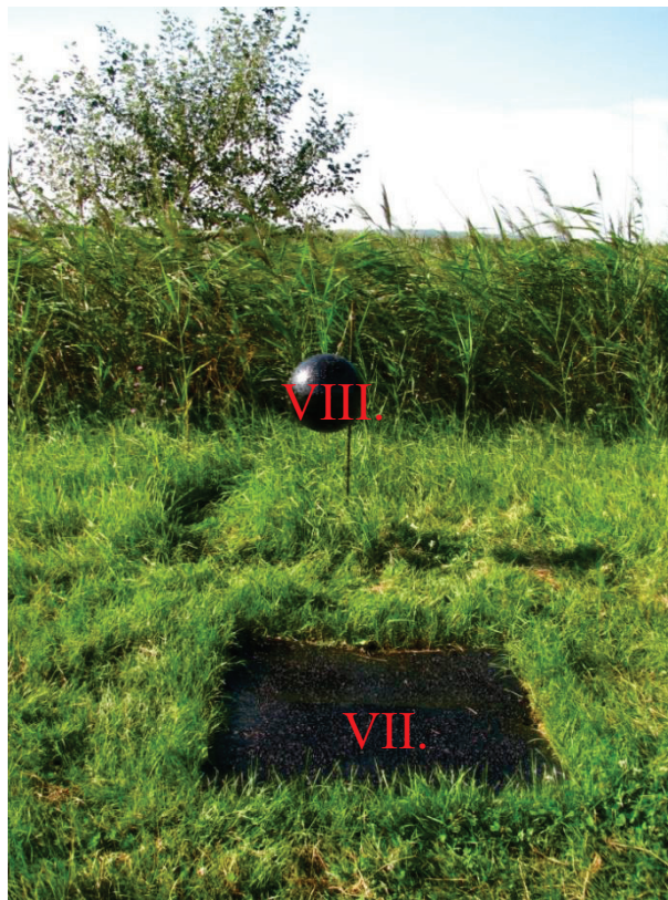
9. kép: VII. 1\text{m}\times 1\text{m} -es vízszintes fényes, fekete műanyag lap a földön, az oldalfelezőknél rögzítve L-vasakkal (Fl); VIII. fényes, fekete, 41 cm átmérőjű gömb a levegőben, legalsó pontjának a földtől való távolsága 60-70 cm (Lg).
